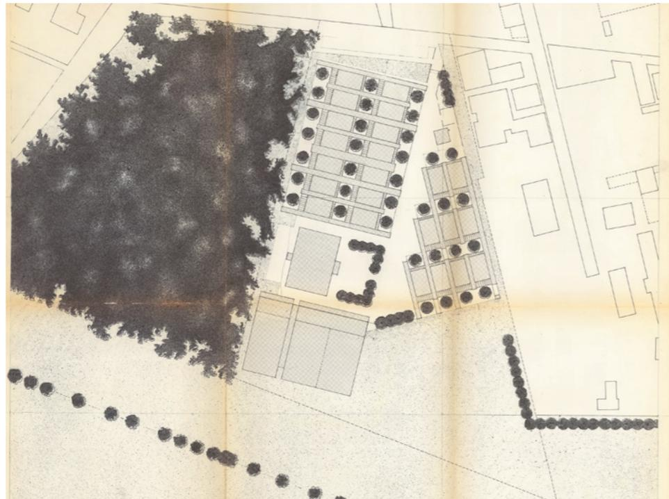
> Figura 23. Livio Vacchini, Scuola elementare Città di Locarno, Piano di situazione, 20 maggio 1973 (AcL). Nella nuova planimetria rielaborata da Vacchini, il secondo blocco di aule è disposto secondo una giacitura di circa 30° rispetto al primo blocco, parallela al confine ovest del lotto, dove si trova un bosco. Tra i due blocchi aule si definisce uno spazio centrale cuneiforme.
