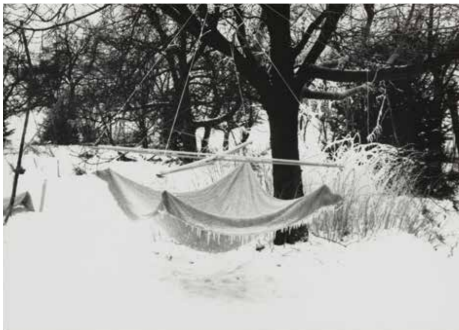
Figura 7. Heinz Isler, esperimenti con membrane appese e congelate (gta Archivio, ETH Zurigo, fondo Heinz Isler).
