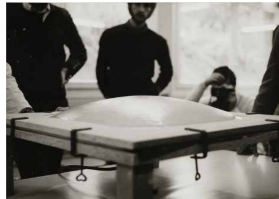
Figura 8. Heinz Isler, modello pneumatico per la determinazione di forme strutturali (gta Archivio, ETH Zurigo, fondo Heinz Isler).
