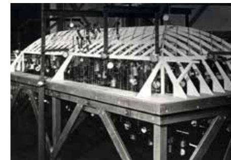
Figura 2. Pier Luigi Nervi, modello in celluloide in scala 1:37,5 dell'Aviorimessa di Orvieto, 1935-1936 (P.L. Nervi, Scienza o arte del costruire? , Roma 1945, tav. III).
