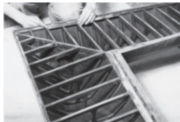
- Fasi del confezionamento del modello elastico in scala 1:36,89 della Cattedrale, 1965 (Archivio Storico ISMES).
