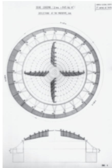
_ Diagrammi di carico sul modello in scala 1:50 della Norfolk Scope Arena (Archivio Storico ISMES).
