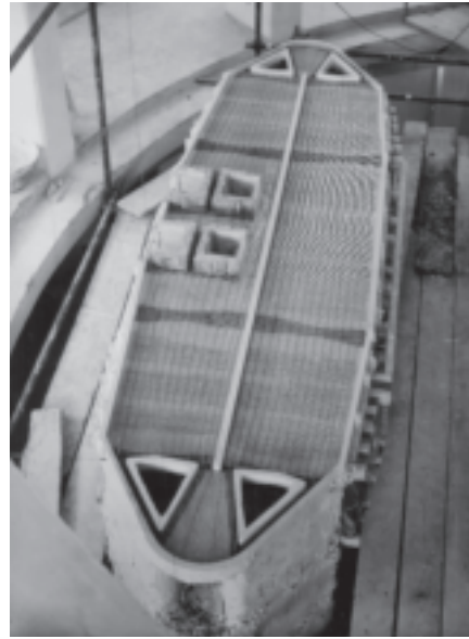
_ Fasi del confezionamento del modello in scala 1:15 del Grattacielo Pirelli, 1955 (Archivio Storico ISMES).
