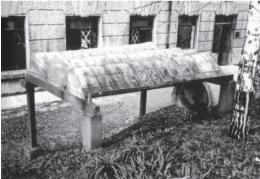
_ Padiglione della Fiera di Milano, modello in scala 1:5 delle "onde" di copertura presso il Politecnico di Milano, 1947. _ Padiglione della Fiera di Milano, modello in scala 1:5 delle "onde" di copertura. In evidenza i blocchetti di cemento che costituivano il carico.
