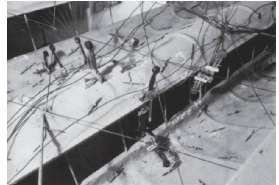
_ Padiglione della Fiera di Milano, modello in scala 1:5 delle "onde" di copertura. In evidenza gli strumenti di misura.
