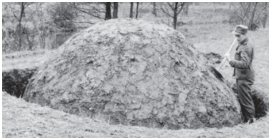
_ Heinz Isler, Freely shaped hill for form finding (da J. Chilton, Heinz Isler , Thomas Telford Publishing, London 2000, p. 19). _ Heinz Isler, osservazioni sul metodo del form finding (da E. Ramm e E. Schunck, Heinz Isler Schalen , Karl Krämer Verlag Stuttgart, 1986). _ Heinz Isler, modello pneumatico per la determinazione di forme strutturali (gta Archiv, ETH Zürich: Nachlass Heinz Isler).
