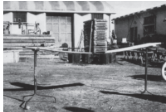
_ Pier Luigi Nervi, campioni di solette ad armatura equidiffusa (MAXXI, Roma). _ Solettina in ferro cementato sottoposta a flessione (MAXXI, Roma). _ Prova di resistenza a flessione di una lastra in ferrocemento (MAXXI, Roma). _ Prove di carico di un arco sperimentale ad elementi prefabbricati per aviorimessa, 1939-1941. _ Magazzino sperimentale in lastre curve di ferrocemento alla Magliana, 1945.
