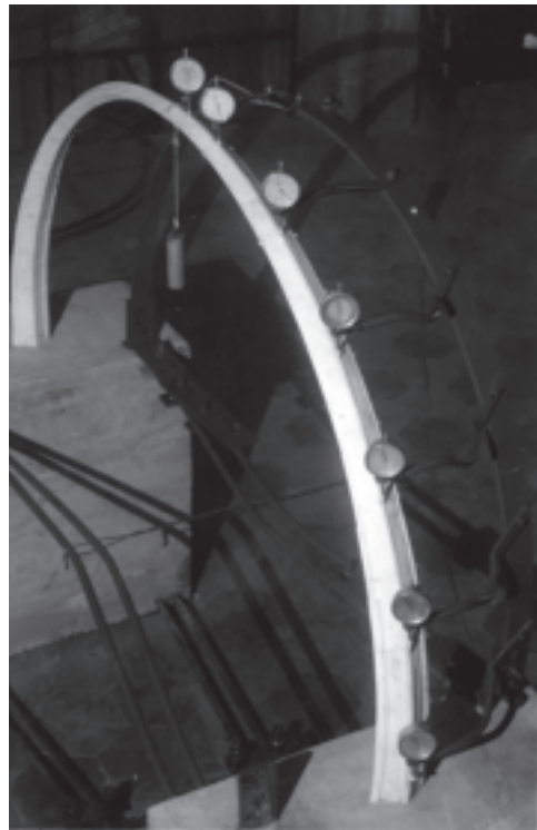
_ G. Quaroni, manifesto ufficiale dell'Esposizione Universale, ottobre 1939. _ Studio sperimentale sul modello dell'arco circolare all'E42 eseguito presso il Politecnico di Milano.
