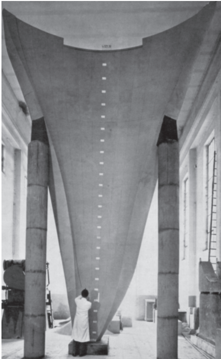
— Modello preliminare in scala 1:35 della diga del Vajont testato all'ISMES (Archivio Storico ISMES).
