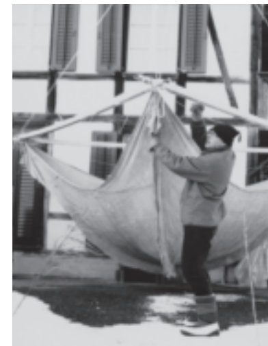
_ Heinz Isler, esperimenti con membrane appese e congelate (gta Archiv, ETH Zürich: Nachlass Heinz Isler).
